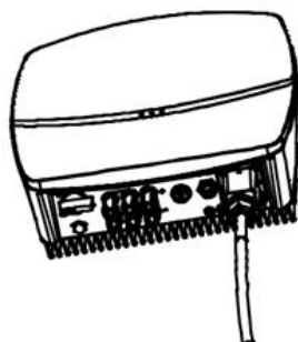
Figuur 5.10 Draai de beschermkap van de AC-interface en de omvormer aan
